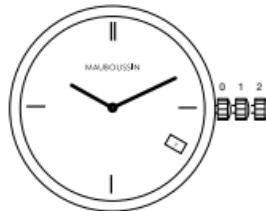
Tirez la couronne initialement en position 0 jusqu'à la position 2 (**cf. schéma p. 2**) et
